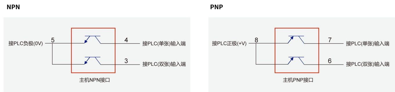
图 3-4：主机输出接口与 PLC 接线图
