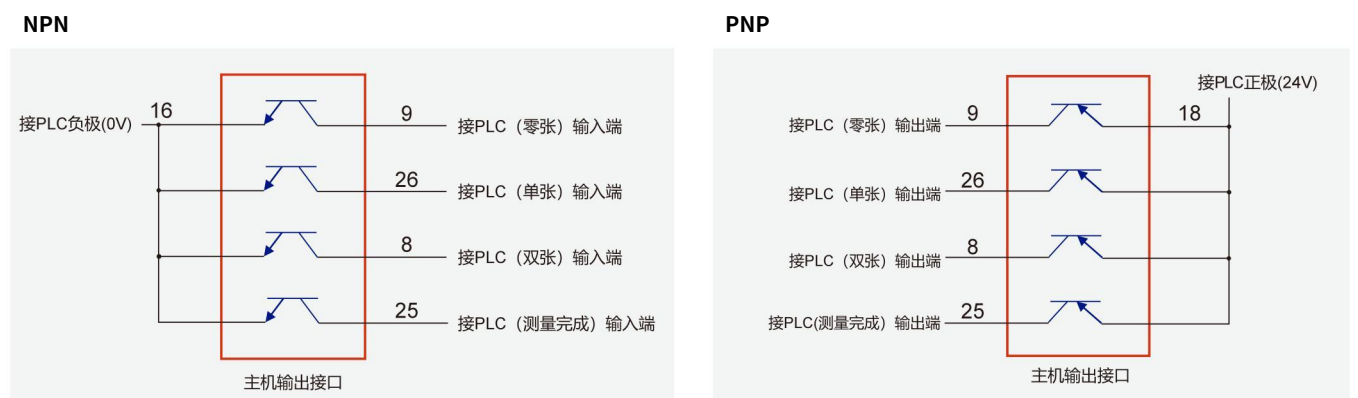
图 2-8：主机输出接口与 PLC 接线图
