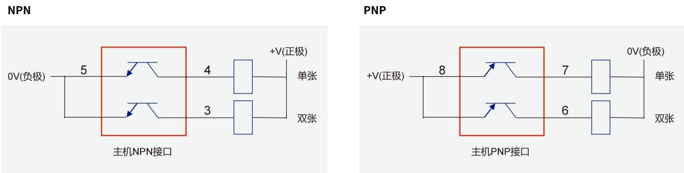
图 3-3：主机输出接口与继电器接线图
