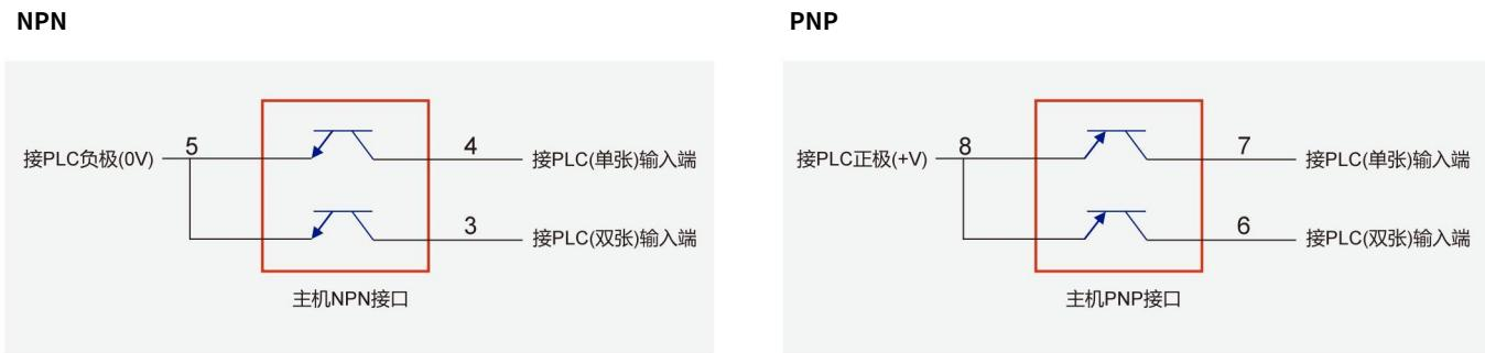
图 3-4：主机输出接口与 PLC 接线图
