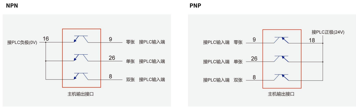
图 2-7：主机输出接口与 PLC 接线图
