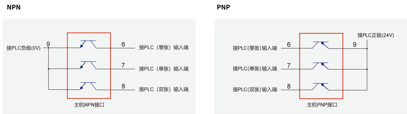
图 3-5：主机输出接口与 PLC 接线图
