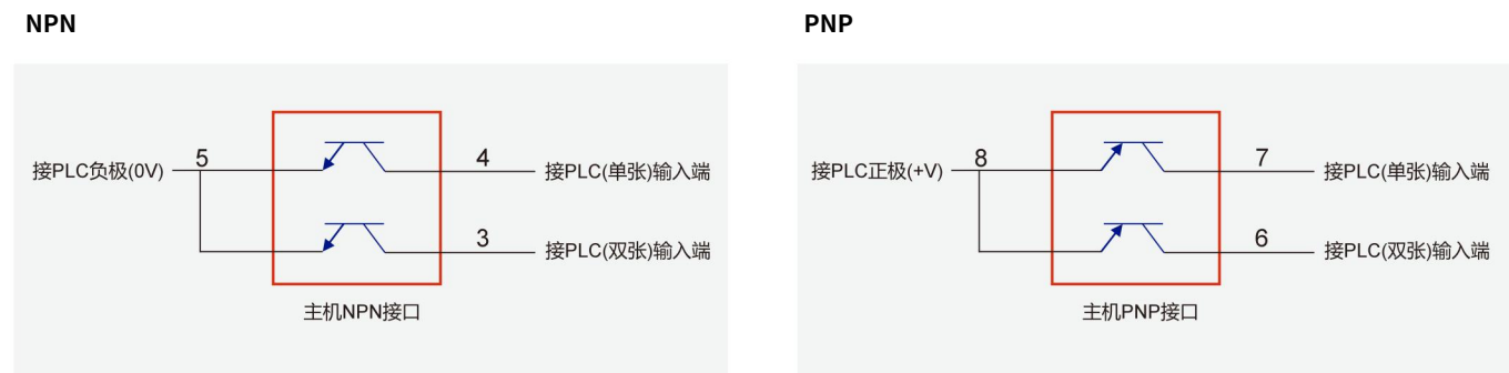
图 3-4：主机输出接口与 PLC 接线图
