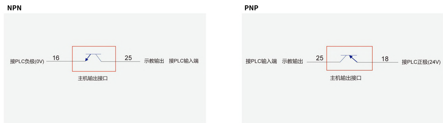
图 2-10：示教输出 IO 与 PLC 接线图
