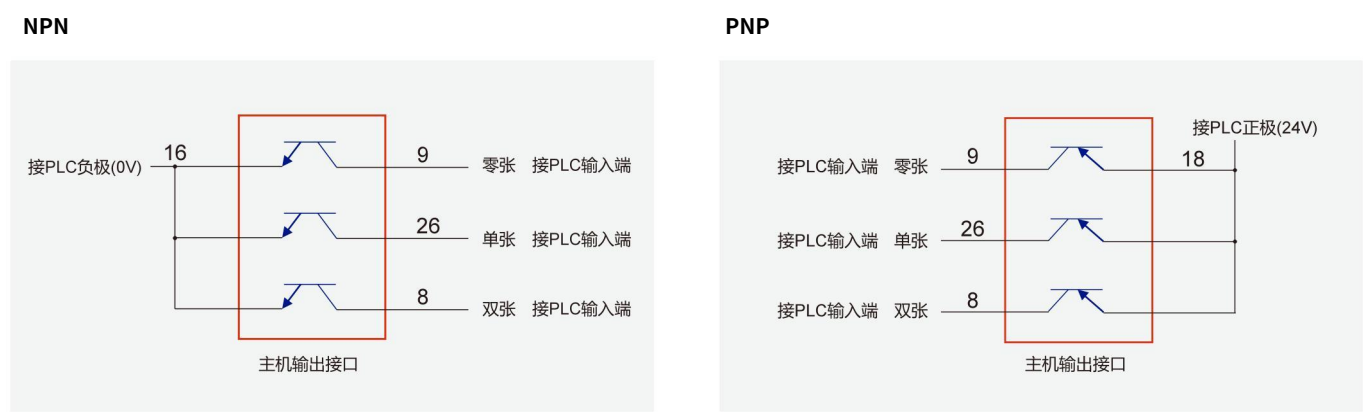
图 2-8：主机输出接口与 PLC 接线图
