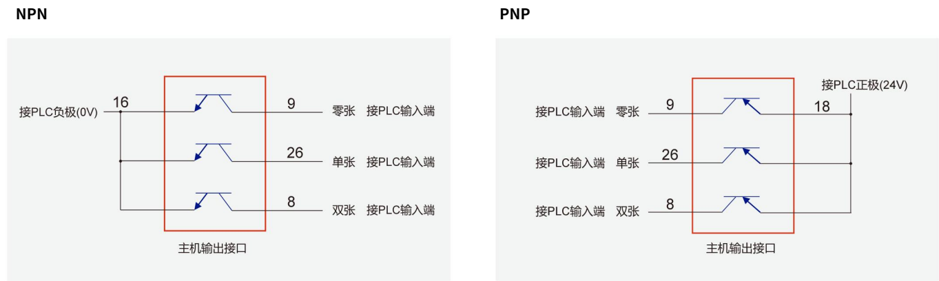
图 2-7：主机输出接口与 PLC 接线图
