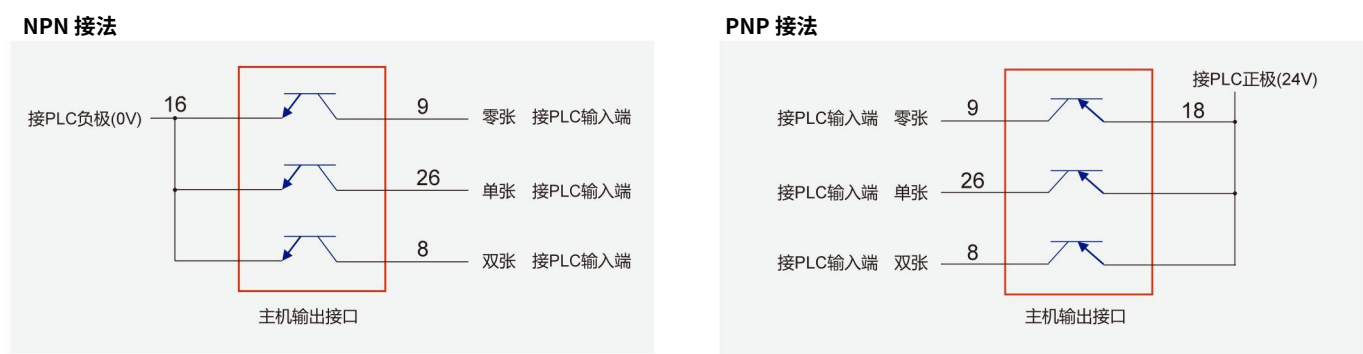
图 2-8：主机输出接口与 PLC 接线图
