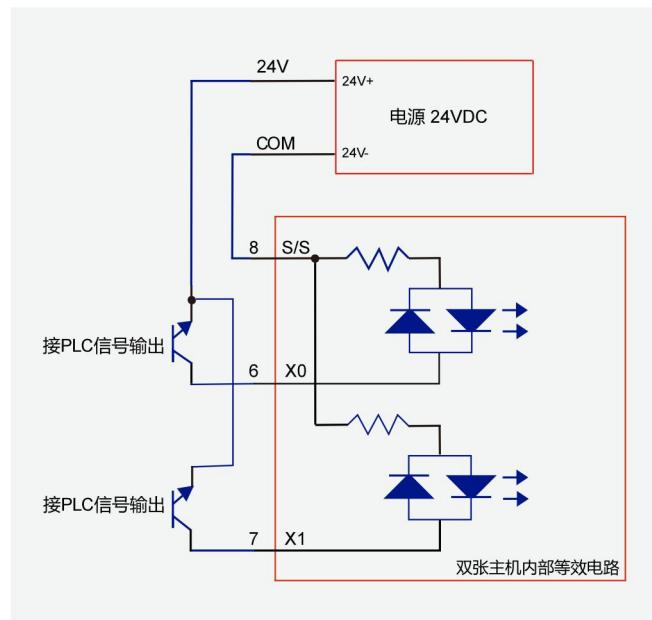
图 3-6：记忆组切换 IO 输入接线图
