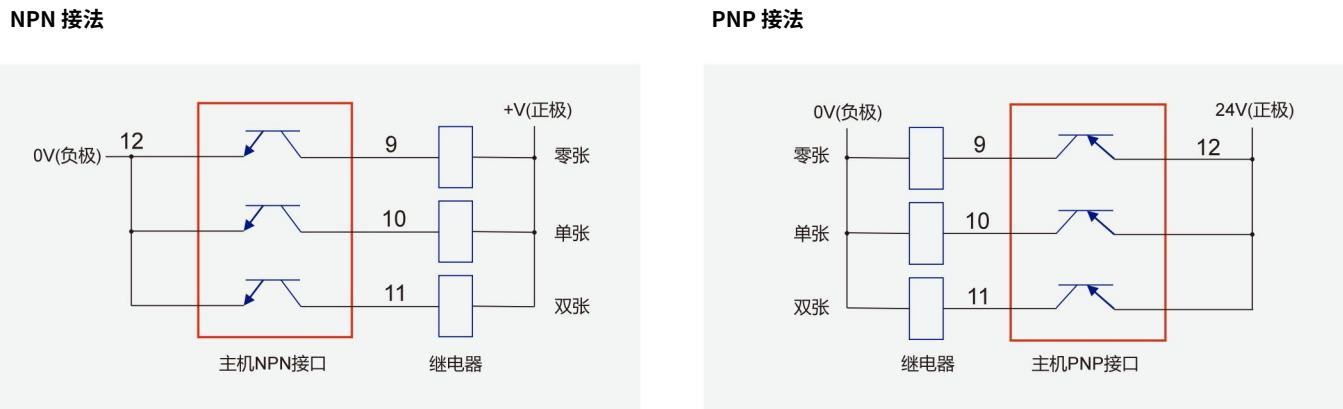
图 3-4: 主机输出接口与继电器接线图
