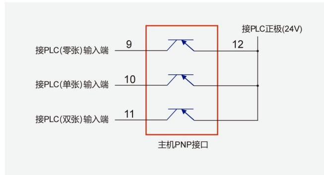
图 3-5：主机输出接口与 PLC 接线图
