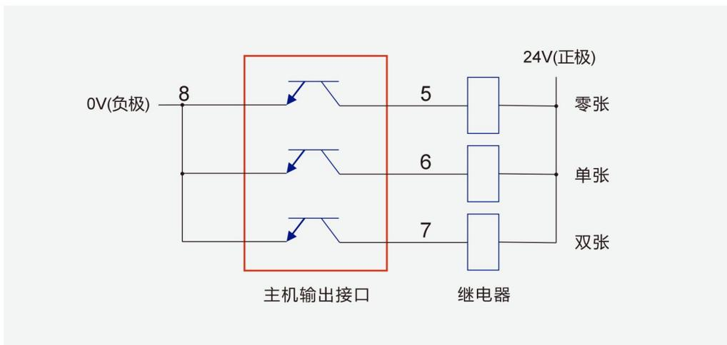
图 3-3: 主机输出接口与继电器接线图
