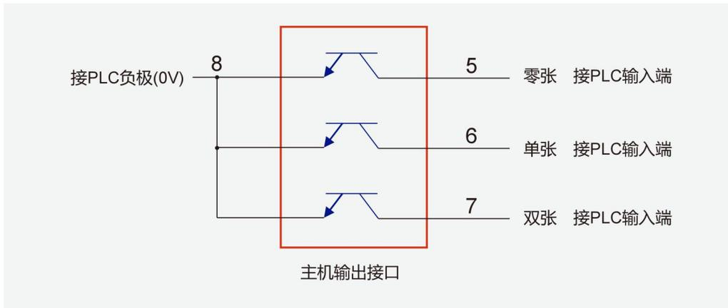
图 3-4：主机输出接口与 PLC 接线图
