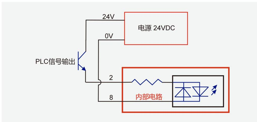
图 3-5：探头测量接线图
